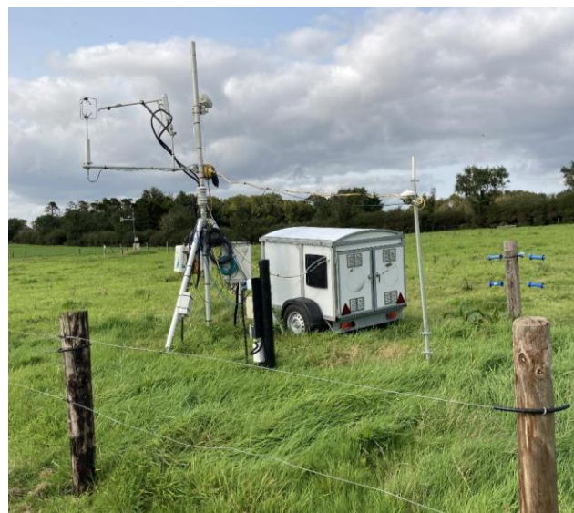
Figur 3: Målestation der kontinuert måler N 2 O og CO 2 .
