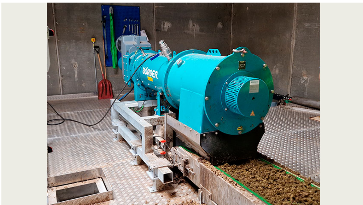
Billede 1. Skruepresse til separering af afgasset biomasse. Foto: Torkild Birkemose, SEGES Innovation.
