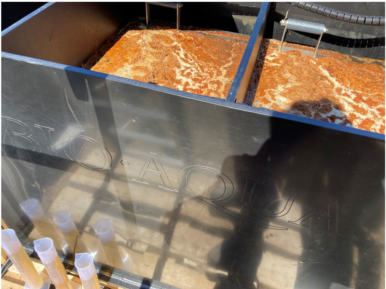
Figur 2: Flokkuleringsenheden fra Bio-Aqua. Det røde skum er organiskmateriale og jern som fjernes fra vandet i flokkuleringsprocessen.
