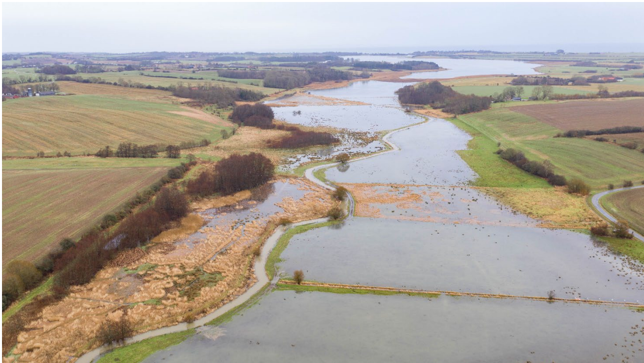
Figur 19: Vådområde omkring Rævs Å i nærheden af Odder. Vådområdet blev etableret for at tilbageholde vand, som det i høj grad gør om vinteren, som det ses her. Foto: Emil Skole Læsø, SEGES Innovation.
