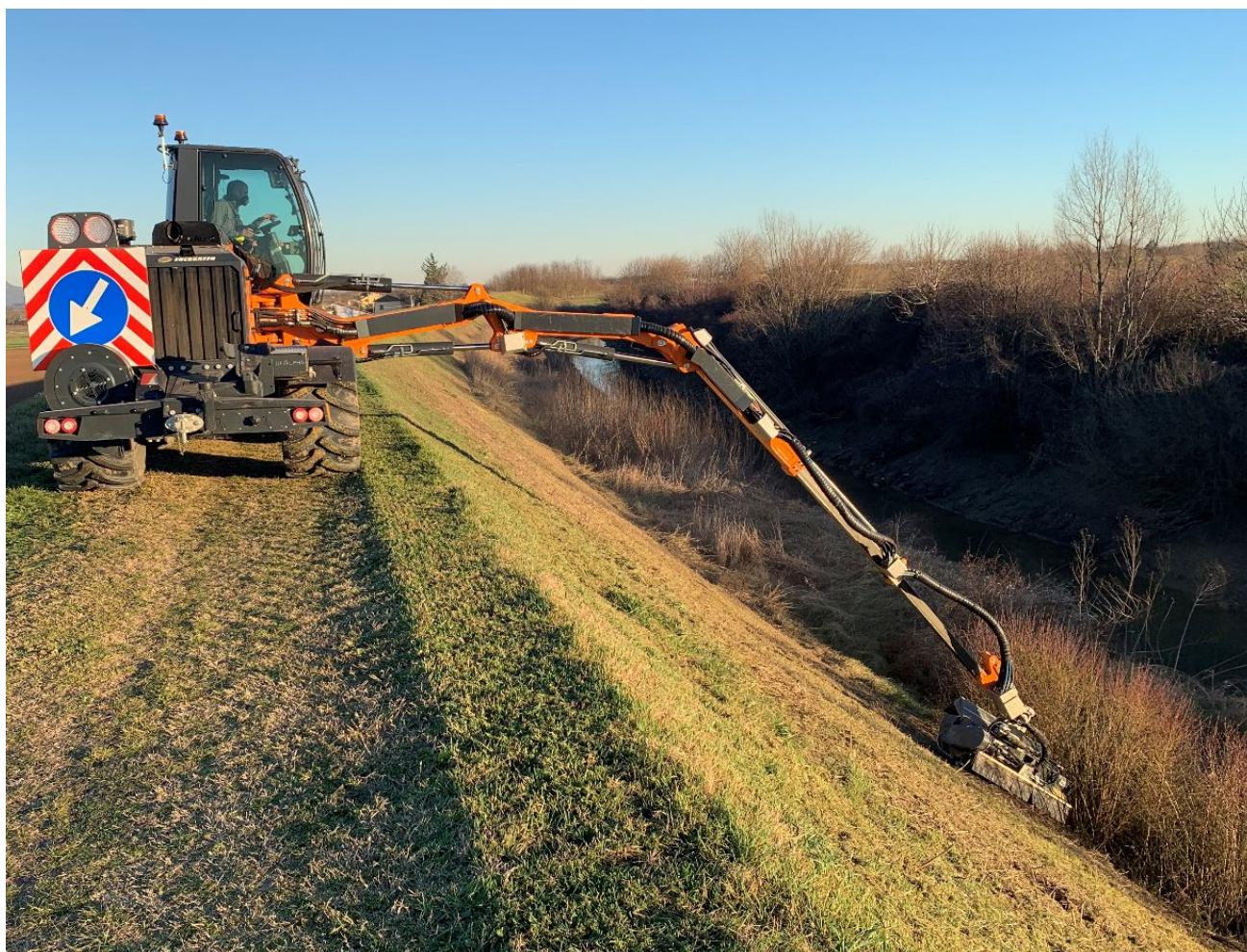
Figur 8: Eksempel på hvordan kantskæring kan foregå med en såkaldt armklipper, der kan styres med en traktor. Foto: Special Maskiner A/S.
