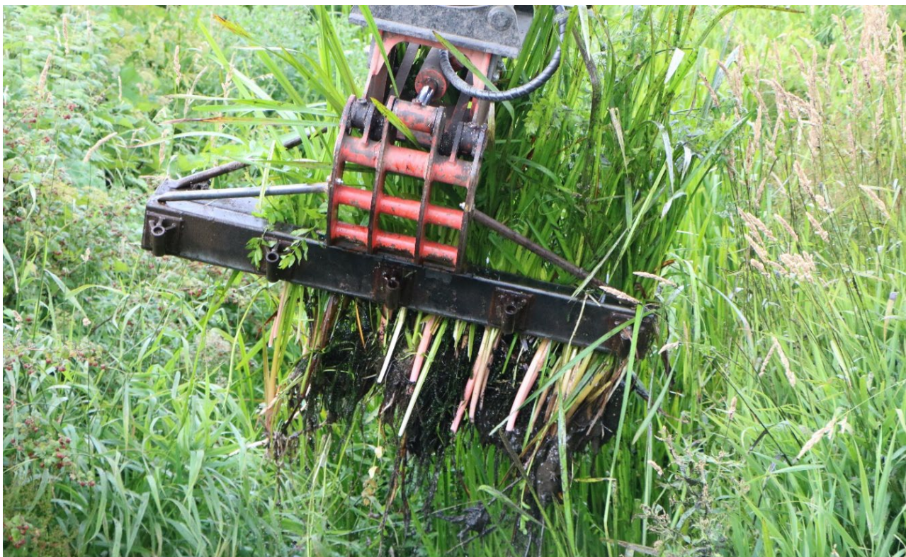
Figur 3: Pincetmetoden er en måde at lave selektiv grødeskæring på. Her trækkes pindsvineknop op med roden. Denne stivstænglede plante bremser vandstrømmen og vokser meget hurtigt frem igen, hvis den blot beskæres. Foto: SEGES Innovation.
