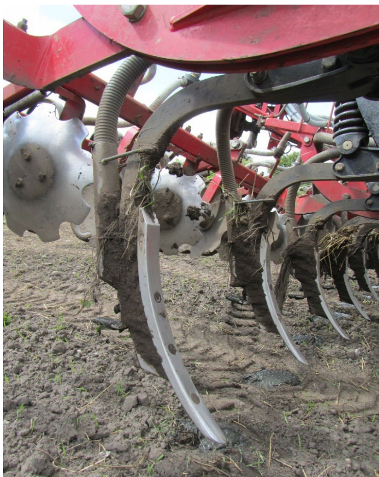
Figur 31: Eksempel på en grubber der kan så efterafgrøder i samme omgang. Foto: SEGES Innovation.
