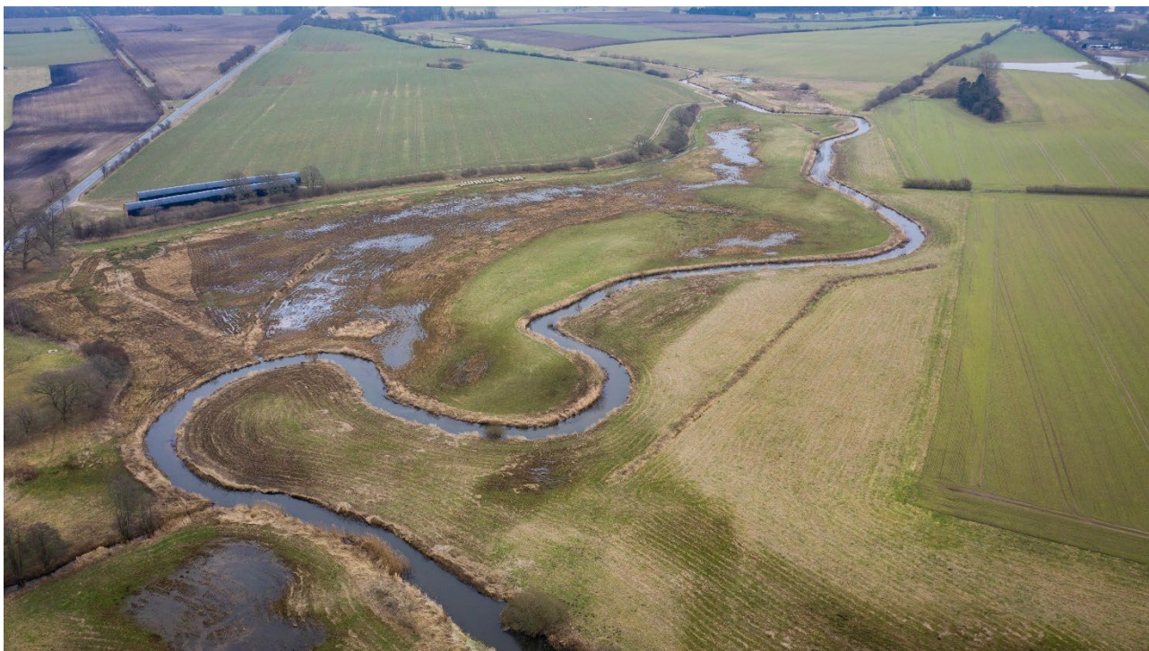
Figur 10: Genslynget vandløb. Markerne helt ned til genslyngingen kan ikke længere bruges til traditionel dyrkning, men til gengæld har det været muligt at bruge arealet til paludikultur, hvor der høstes dunhammer, tagrør og lignende til biogas, byggematerialer, m.m. Foto: Emil Skole Læsø, SEGES Innovation.
