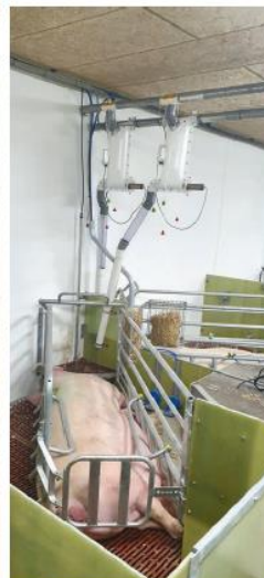
Billede 4: Eksempel på integreret løsning af snegl og foderkasse i st til løsgående søer (Foto: SKIOLD).
