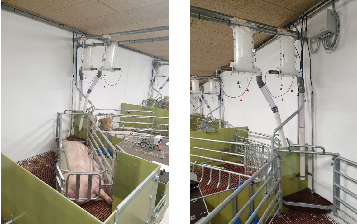
Figur 2. Billeder af SmartFeeder. Bemærk at der er monteret to foderstrenge som muliggør fasefodring af søerne omkring faring (Fotos; Skiold).
