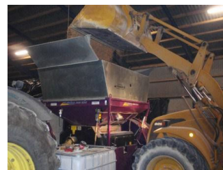
Crimper til valsning af vådt korn.
