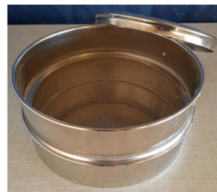
Skiold-handsigte med 1 mm sold. Sigtetid 2 minutter. Velegnet til alle dyregrupper.
