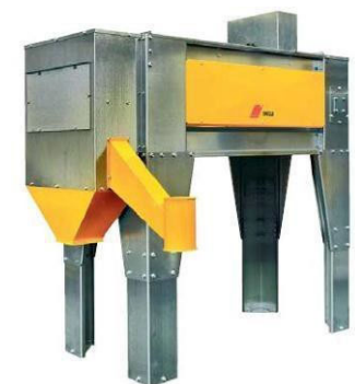
Soldrenser - fjerner både skalddele, sand og sten.
