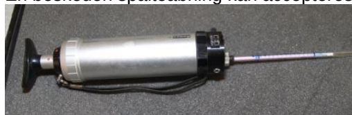
Pumpe og rør til måling af ammoniak
