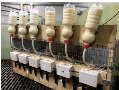
Figur 3. Fronten af den opdelte kasse med det kunstige yver. Til venstre ses de tre flasker med mælkeerstatning (hvid væske), og til højre ses de tre flasker med ko-råmælk (mere gullig væske). De hvide bokse var strømforsyning og styring til varmeelementerne.
