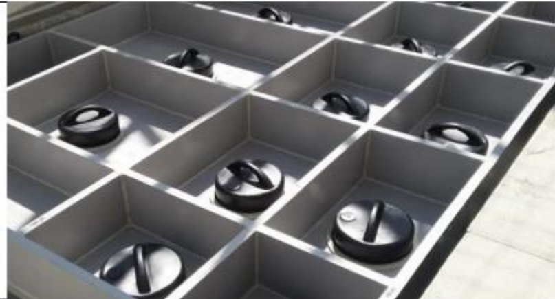
Figur 3. Gødningsopsamlingsbakke med gylleprop i hvert rum.
