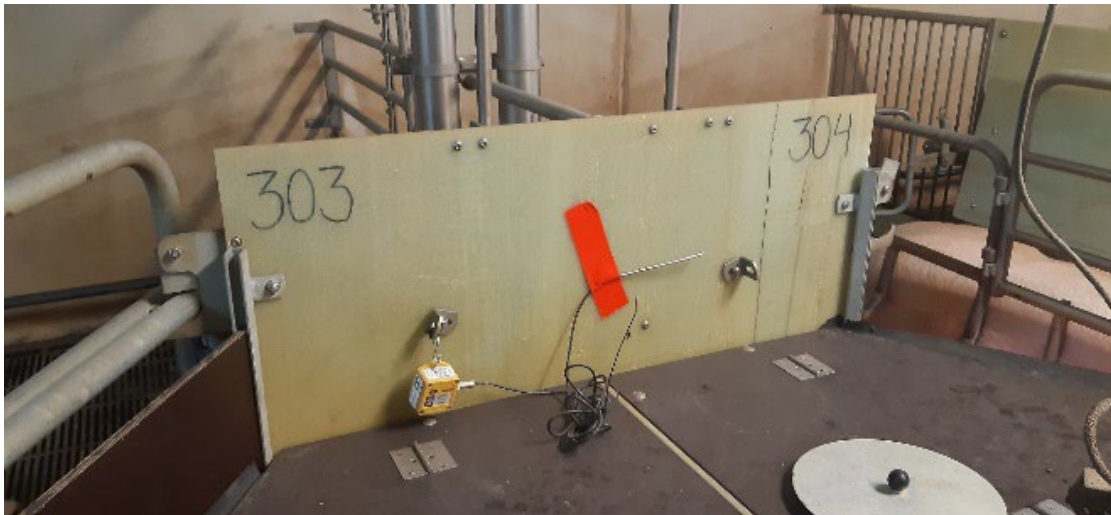
Figur A4.2. Placering af TinyTags til temperaturmåling
