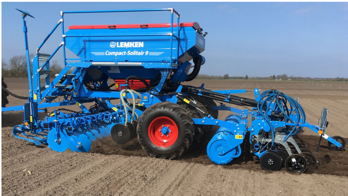
Såmaskine der er udstyret med godningskær og en pakvalse før såsektionen, som består af dobbeltskiver med trykrulle i såsporet. Foto: Torben S. Frandsen, SEGES Innovation.
