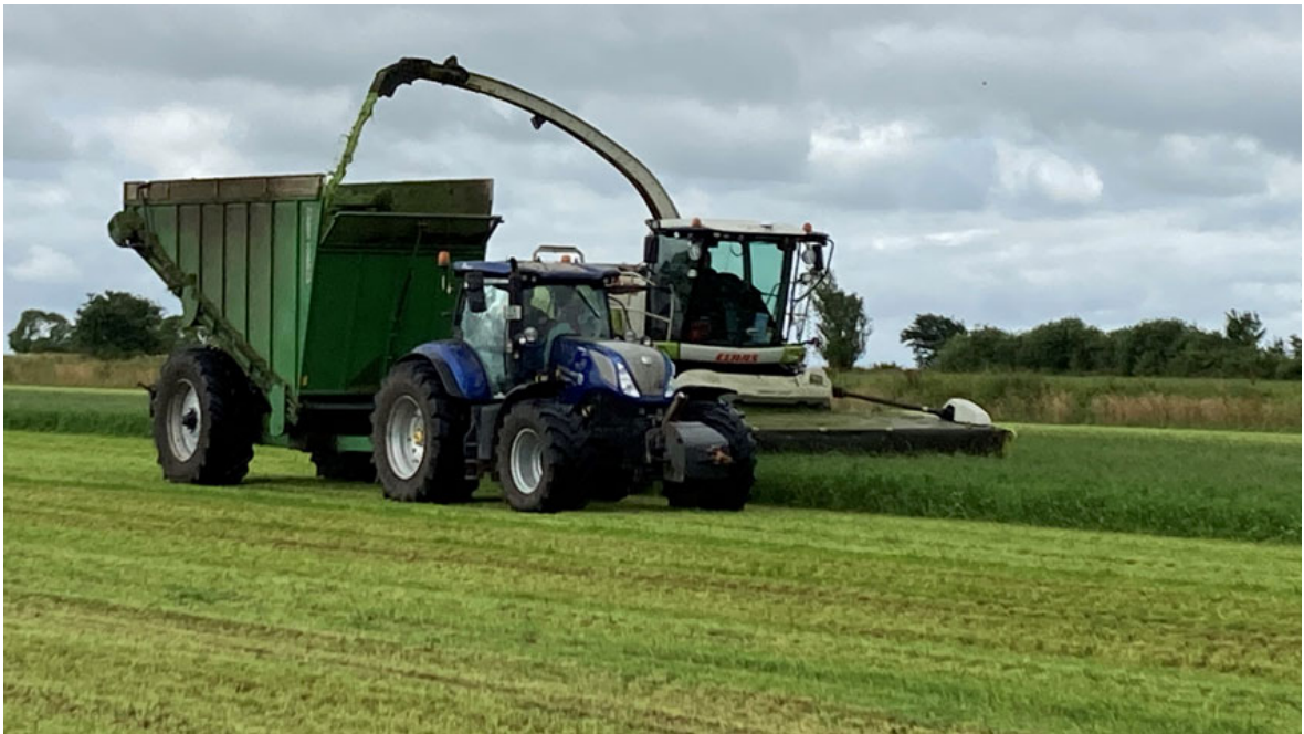
Finsnitte med helsædsbord og frakørselsvogn til overlæsning i lastbiler. Foto: Torben S. Frandsen, SEGES Innovation.
