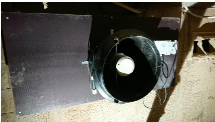
Billede 4. Montering af målevinger på luftstrøm fra punktudsug.
