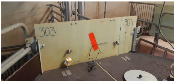
Figur A4. Foto af placering af TinyTags til temperaturmåling.
