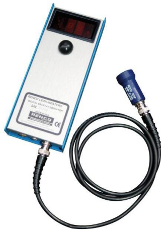
Figur 1A. Illustration af Lean-Meater fra Renco Corporation. I displayet vises rygspæktykkelsen i mm, og samtidig angives, om målingen omfatter et, to eller tre rygspæklag med tre små prikker. Billede anvendt med tilladelse fra MS Schippers Danmark.
