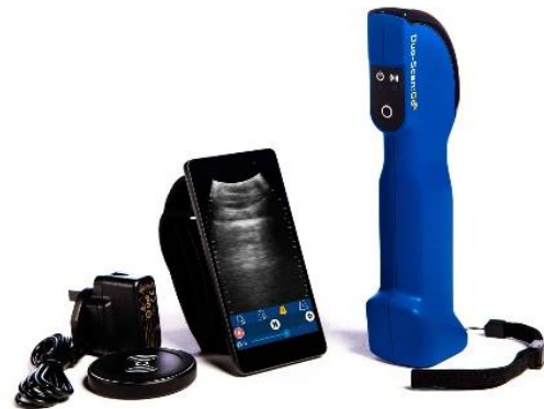
Figur 2A. Illustration af Duo-Scan:Go Plus fra IMV Technologies. Scanningsbilledet ses med enten smartphone eller tablet, som kobles til scanneren via WiFi. Scanningsbilledet vises grafisk, så rygspæklagene ses, og under disse ses overgangen til rygmuskulaturen. Billede anvendt med tilladelse fra Kvægdyrlægerne Kronborg.
