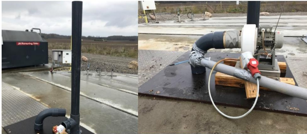
Figur 3. Afkastet var placeret i midten af procestanken på lokation B. Der blev monteret en blæser til at sikre et konstant sug ud af tanken. Måleslange blev monteret på sugesiden ca. 50 cm før blæseren.
