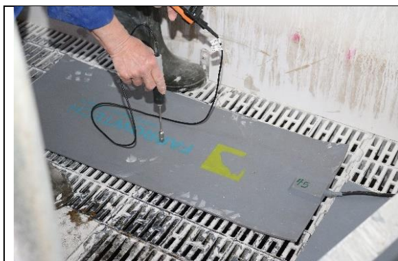
Figur 6. Test af varmemåtterne inden brug i 12 punkter.
