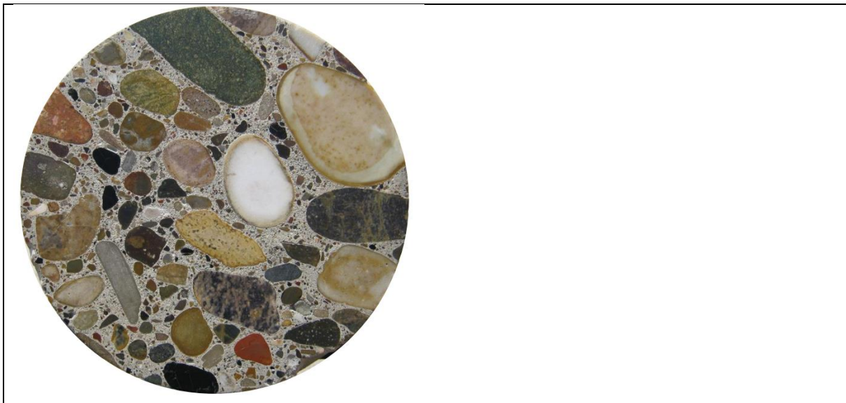
Figur 3. Planslib af en borerkerne af beton, hvor det tydelig ses, at tilslagsmaterialerne (sand og sten) er bundet sammen af en masse bestående af cement og vand [4].
