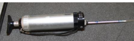
Pumpe og rør til måling af ammoniak.
