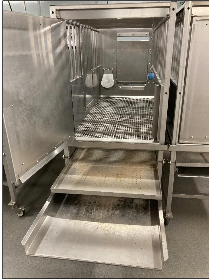
Balanceburene er designet så gødning og urin kan opsamles særskilt.
