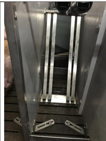
Figur 7. Metalpinde i retursluserne var hængt op de første dage grisene var i stien.
