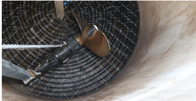
Forsøgsgyllebeholder med køleslanger og omrører.
